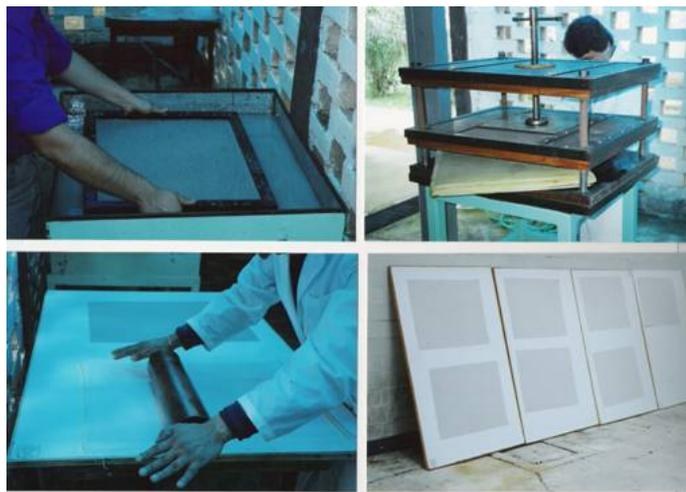
Fig. 2. Método TeoCart para la fabricación de papel hecho a mano en el Departamento de Madera Celulosa y Papel de la U de G.
